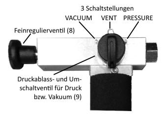
Drehen Sie das Feinregulierventil (8) durch Drehen entgegen der Uhrzeigerrichtung ganz heraus, bis ein leichter Anschlag zu spüren ist.
