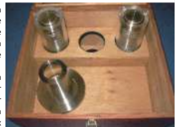
Kolben-Zylinder-System und Glocke der Druckwaage LR-Cal LDW-P in optionaler Holzkiste
