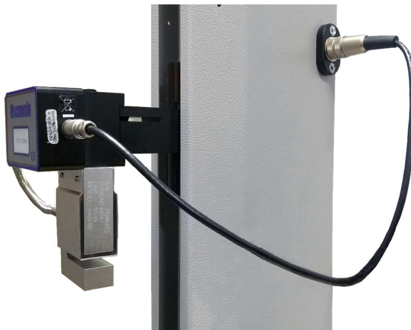
▲ Connecting the 6-pin plug to the ELS
